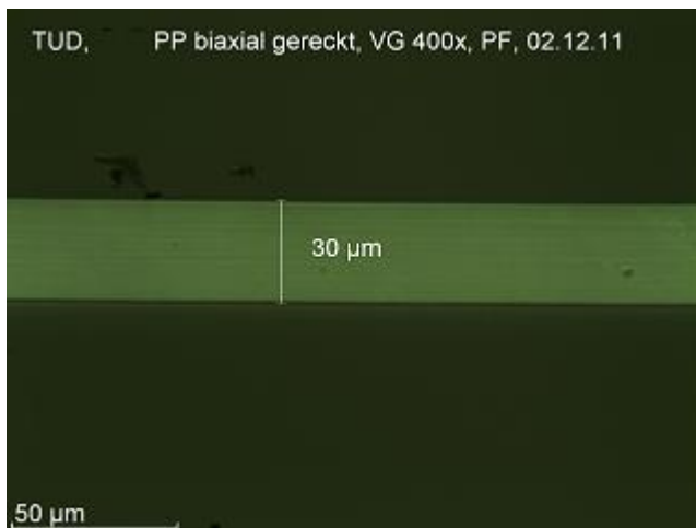
Abbildung 56: Mikrotomschnitte zur Verdeutlichung des Schichtaufbaus der Folien
