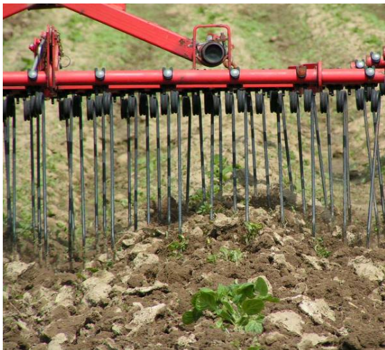
Einsatz des Striegels im Kartoffelanbau
