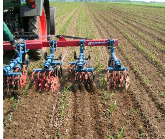
Einsatz der Rollhacke im Maisanbau
