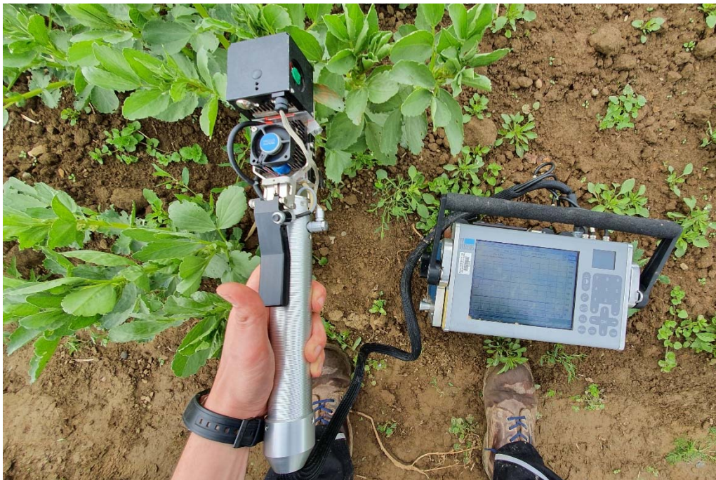
Abb. 522: Messung zum stomatären Gaswechsel mit dem Photosynthesegerät „CIRAS-2“ am 28.05.2020 am Standort Helbigsdorf (Foto: Scholz 2020)
