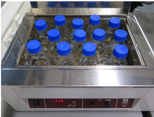
Abbildung 5: Wasserbad zur Überprüfung der Verdaulichkeit In vitro
