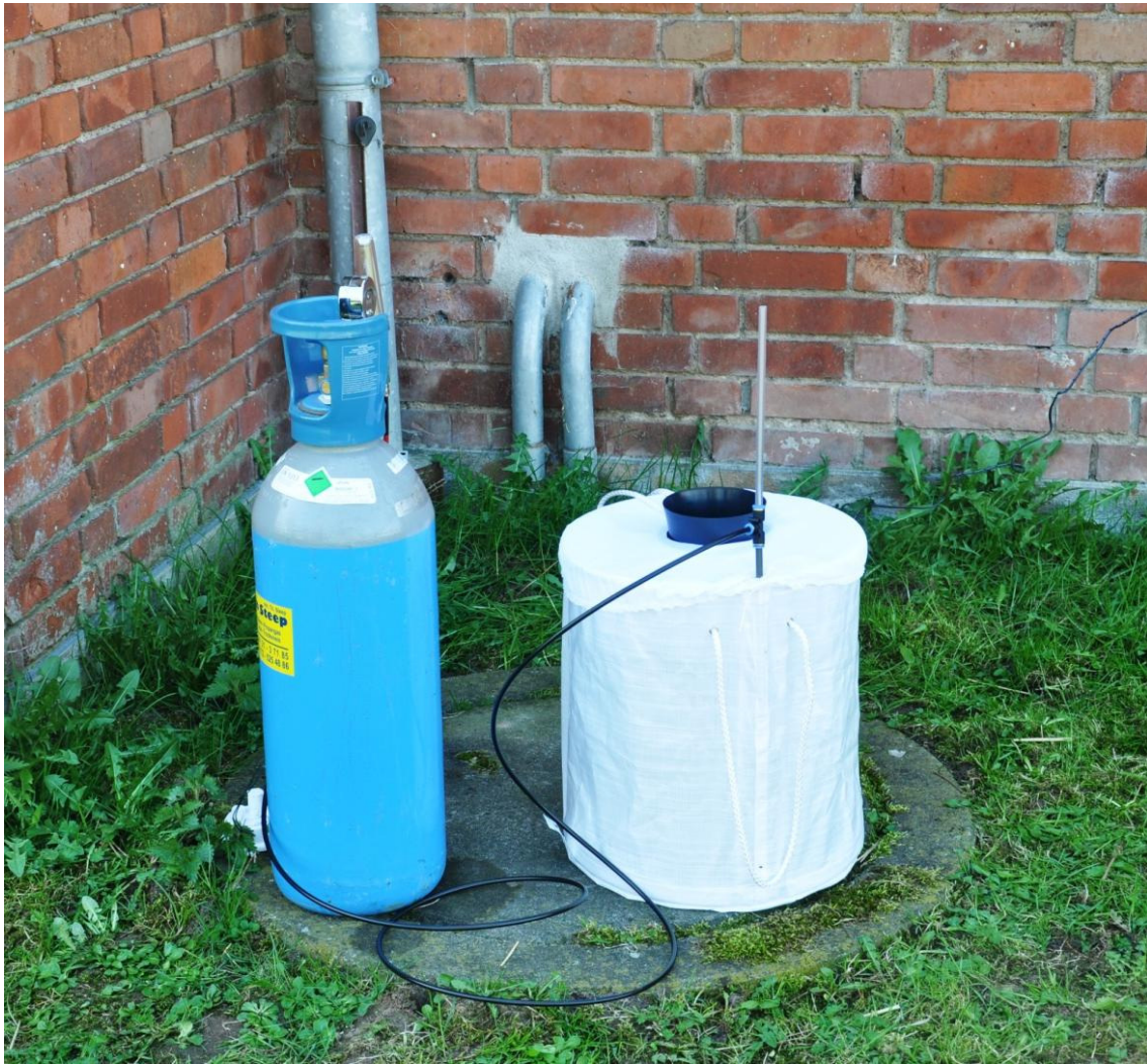
Abb. 2: BG-Sentinel-Falle mit 10 kg CO 2 -Kurzflasche
