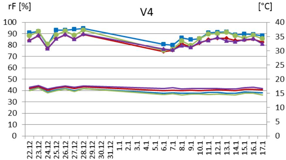
**Abb. 9a:** Temperatur und rel. Luftfeuchtigkeit (rF) im Bestand von Basilikum bei einer Vorlauftemperatur in den Heizrohren von 40°C und in Abhängigkeit vom Abstand der Heizrohre zum Tisch: 22 cm (blau); 15 cm (rot); 9 cm (lila); 0 (grün); aus vier Basilikumsätze (V1, V2, V3, V4) um 6.00 Uhr
