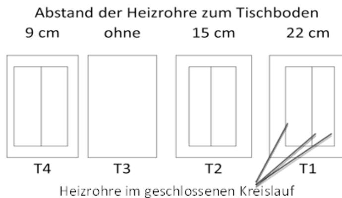
**Abb. 3:** Versuchsaufbau in den Gewächshauskabinen zur Prüfung des Einflusses der Kulturführung auf die relative Luftfeuchtigkeit; Tischen ausgestattet mit Heizrohre (T1, T2, T4) und ohne Heizrohre (T3)
