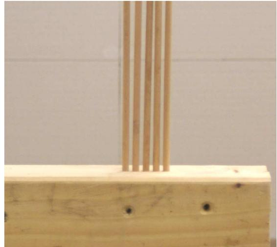
Der gebohrte und mit Buchenstäben versehene Balken ist auf einer stabilen Unterlage so befestigt worden, dass eine seitliche Verschiebung möglich war, damit bei notwendigen Korrekturen der Treffpunktlage schnell reagiert werden konnte. Die Höhe des Aufnahmebalkens gewährleistete eine senkrechte Schussabgabe (im Winkel von  $90^\circ$ ) auf die Stäbe.
