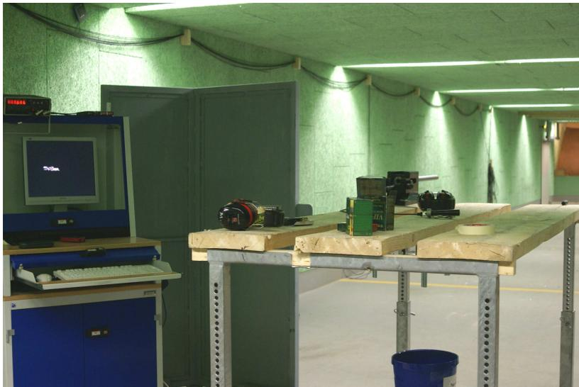
In der Raumschießanlage haben wir 25 m vor dem Sandfang den Verschlussbock mit Lauf positioniert, um die  $v_{25}$  zu ermitteln
