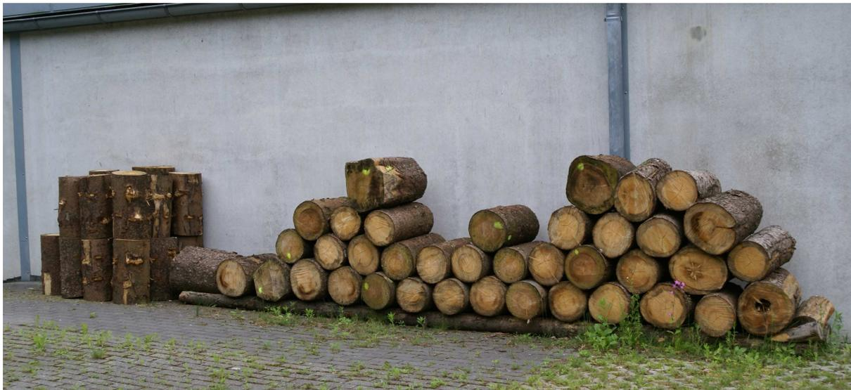
Im obigen Bild ist die benötigte Holzmenge für beide Versuche zu sehen. Bei der Verwendung zu den Schrotversuchen wurden die Stämme nochmals geteilt, so dass Stammstücke mit einer Länge von lediglich ca. 25 cm verwendet wurden. Eine Mehrfachnutzung ist durch den Einzelschrotbeschuss in allen Fällen möglich gewesen, so dass der Materialeinsatz gering war.
