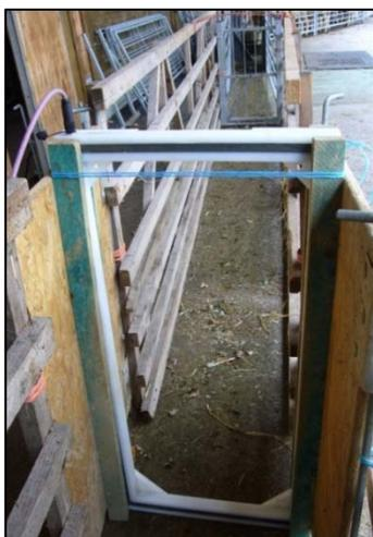
Abb. 4: Durchlaufantenne im Treibgang
