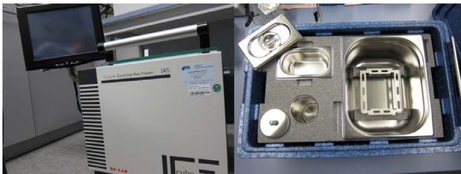
Abb. 01: Controlled Rate Freezer (oben) und Stickstoff-Einfriereinheit für Pailletten
