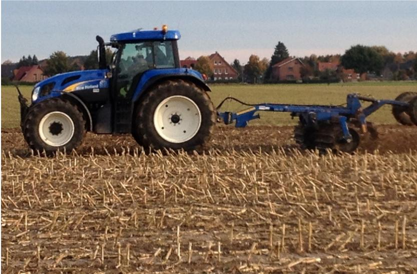
Abb. 1: Einsatz einer Messerwalze zur Maisstoppelzerkleinerung auf dem Betrieb 3
