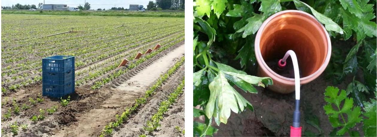
Abb. 2: Ansicht der Messeinrichtung zur Ermittlung der Nitratauswaschung (links) mit 4 Saugkerzen und Datenlogger zur Erfassung der Bodenfeuchte (blaue Kisten). Rechts Detailaufnahme der Saugkerze mit geöffneter Schutzabdeckung.
