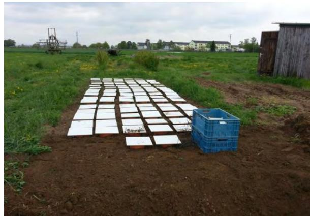
Abb. 5: Einbau und Abdeckung der Bodensäulen auf dem Versuchsfeld Rinkenbergerhof der LUFA Speyer (links). Wieder verfüllte Bodengrube nach Abschluss der Beprobung der ersten 15 Standorte (rechts) mit zwei zusätzlichen Bodensäulen zur Erfassung der Bodenfeuchte und Bodentemperatur im Vordergrund.
