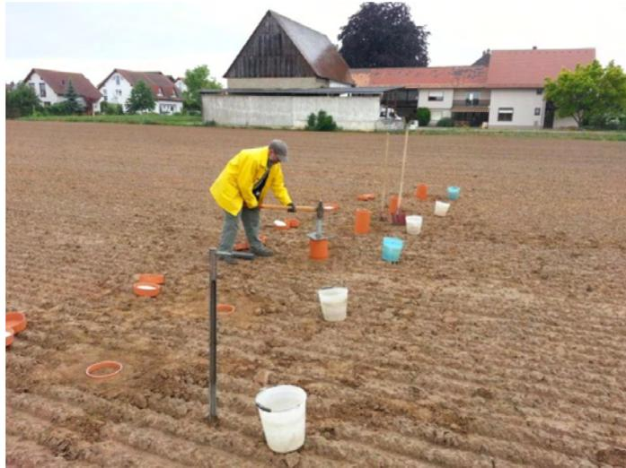
Abb. 4: Entnahme der Bodensäulen zur Charakterisierung der der standortsspezifischen N-Mineralisierung auf einem Gemüsestandort.
