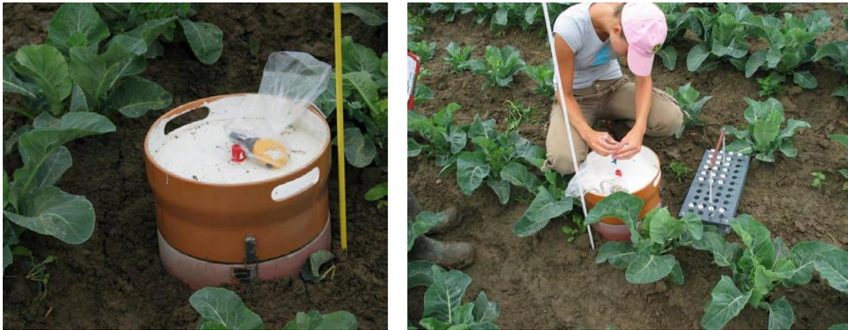
Abb. 3: Aufgesetzte Kammer mit fest eingebautem Bodenring (links) und Durchführung der Gasprobenahme mit evakuierten Glasvials (rechts).
