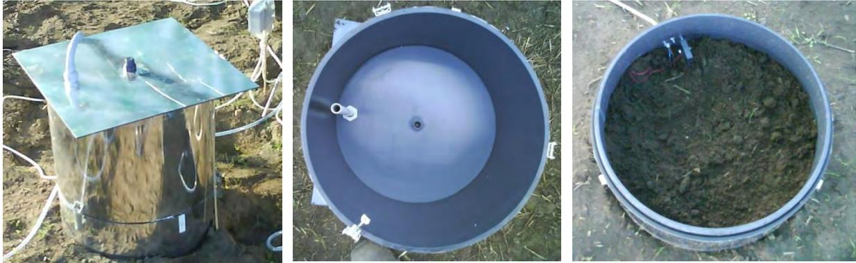
Abb. 1 Haubentechnik. Haubenbasis + Haubenkammer (links), Haubenkammer von innen, hier ohne Filterhalterung (Mitte), eingebaute Haubenbasis (rechts).
