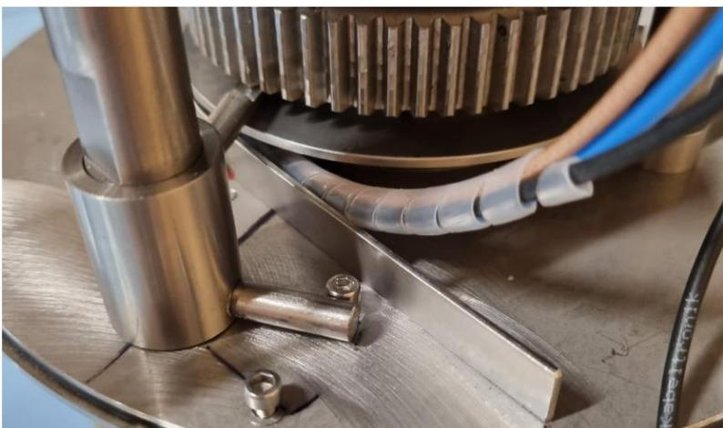
Abbildung 1-8: flexibler Anschlag am Beispiel der Hauptdrehachse
