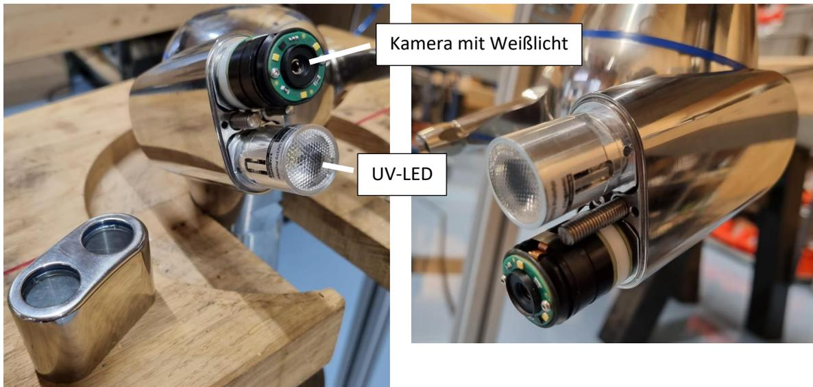
Abbildung 1-7: Aufbau Sensoreinheit mit allen Komponenten
