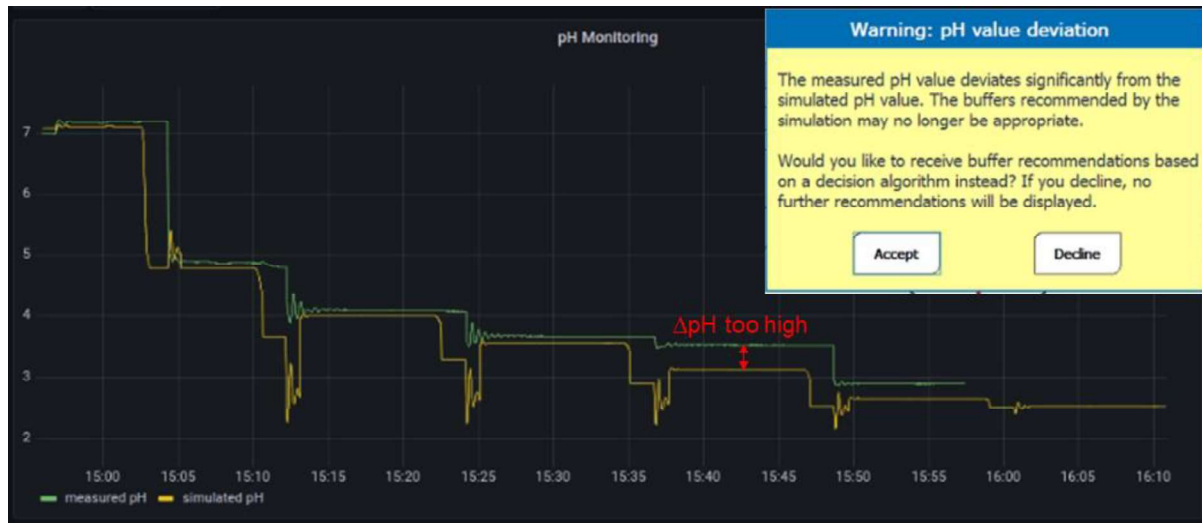
Abbildung 7: Vergleich zwischen dem prädiktiven pH-Wert (gelb) und dem online gemessenen pH-Wert (grün). Im Falle einer Diskrepanz zwischen diesen beiden Werten wird ein Pop-Up-Fenster eingeblendet, um den Operator zu informieren.
