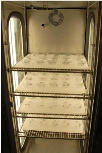
Abb. 12: Versuchsaufbau der Fütterungsversuche mit Dihydropinidin bei Dickmaulrüssler-Arten unter standardisierten Bedingungen im Klimaschrank
