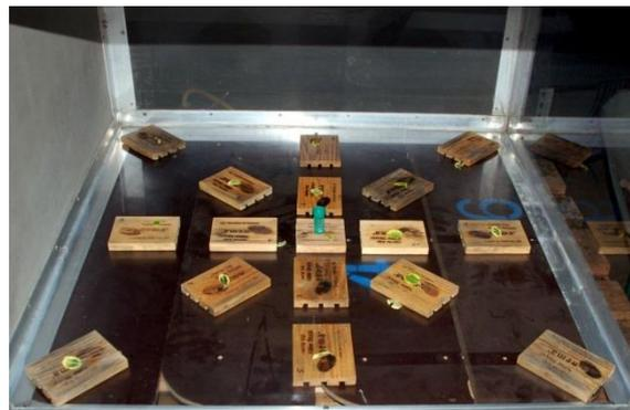
Abb. 9: Versuchsaufbau im Insektenkäfig (l.) zur Prüfung von Lockstoffen bei verschiedenen Dickmaulrüssler-Arten. Lockstoffbehälter (Mitte), Blätter als Futter, Holzbrettern als Versteckmöglichkeit (r.)
