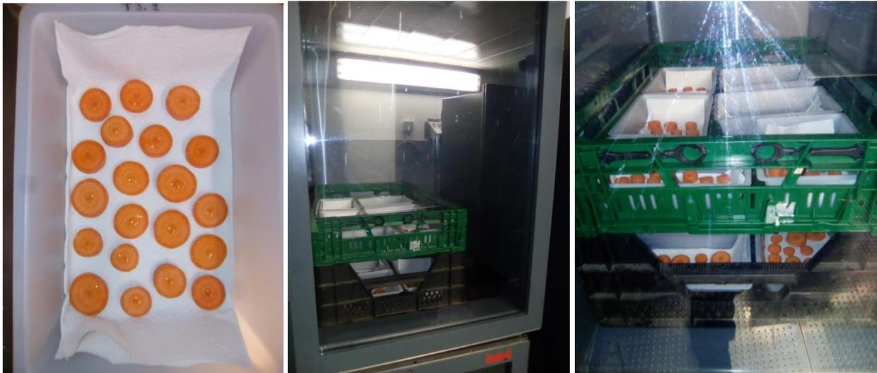
Abbildung 7: Versuchsdurchführung zur Inaktivierung anhaftender *Chalara*-Sporen mittels modifizierter Lageratmosphäre: a) inokulierte Möhrenscheiben, b + c) inokulierte Möhrenscheiben in den Lagerboxen bei kontrollierten Lagerbedingungen; LTZ Augustenberg.
