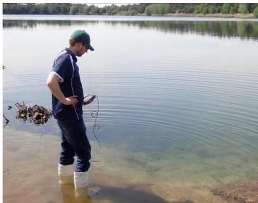
**Foto 6:** Messung von Sauerstoff mittels WTW-Messgerät.
