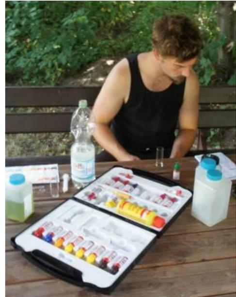
**Foto 10:** Grobe Bestimmung der chemischen Wasserparameter vor Ort mit einem Testkoffer aus der Aquaristik.
